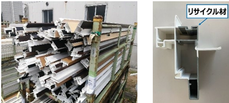
（左）樹脂窓の製造過程で発生する樹脂端材 （右）樹脂端材から得た再生原料を使用した樹脂形材（灰色部分がリサイクル材）
