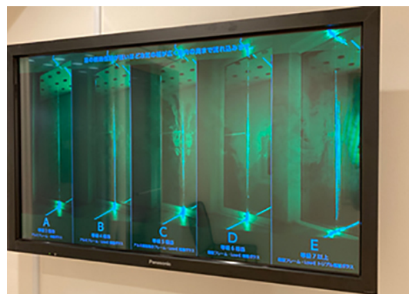
A・Bのアルミサッシでは、スモークが勢い良く下方へ降りていきますが、C（アルミ樹脂複合窓）、D・E（樹脂窓）では、断熱性が高く窓まわりが冷えにくいためほとんどスモークが動きません。
