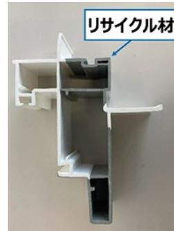
(左) 樹脂窓の製造過程で発生する樹脂端材 (右) 樹脂端材から得た再生原料を使用した樹脂型材（灰色部分がリサイクル材）
