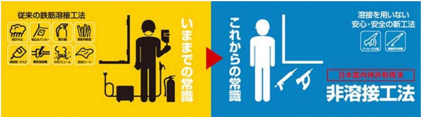
非溶接工法とは、従来の溶接工法に替わる新しいサッシの施工方法です。RC造の建物には樹脂材の硬化によってサッシを固定する「高強度樹脂接合」、S造（ALCパネル納まり）の建物には「アジャストアンカー接合」を展開しています。
