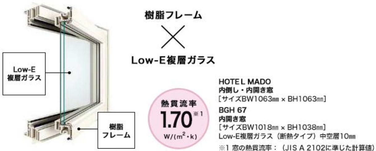
マルチチャンバー構造とLow-E複層ガラスで高断熱に
