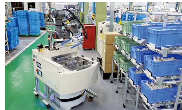
黒部越湖製造所では、2026年2月に窓部品(クレセント等)の自動組立ラインで夜間無人化の本格運用を開始
