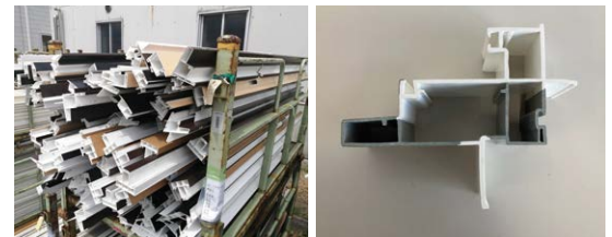
(左)樹脂窓の製造過程で発生する樹脂端材。(右)樹脂端材を再利用した樹脂型材(灰色部分がリサイクル材)
