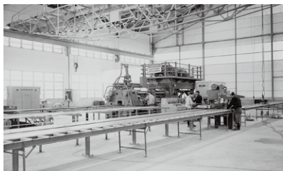
1959年に設置したアルミ押出機
