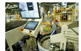
年間6億本のねじを製造。全数検査の様子
