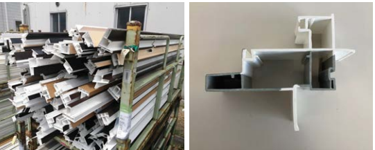
(左)樹脂窓の製造過程で発生する樹脂端材。(右)樹脂端材を再利用した樹脂形材(灰色部分がリサイクル材)
