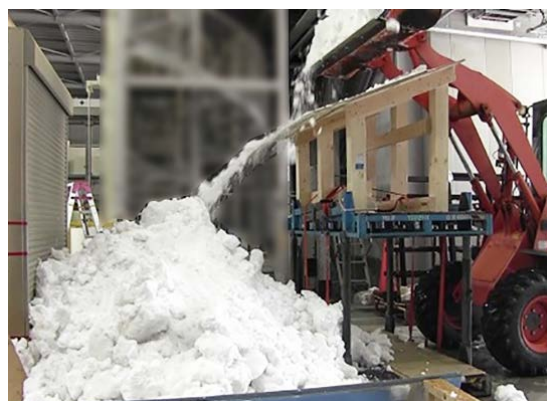
落雪を再現したシャッター側圧検証
