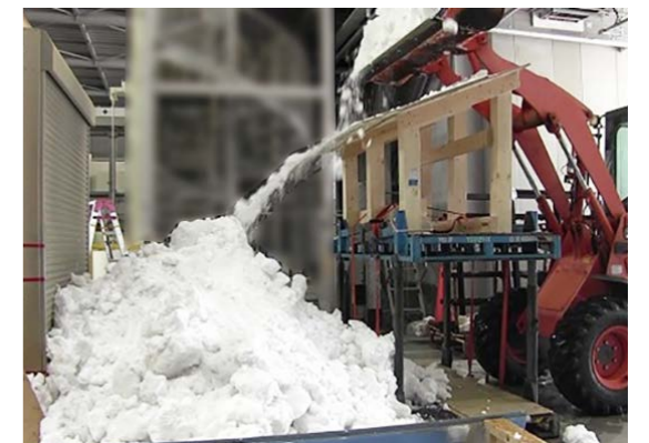
落雪を再現したシャッター側圧検証
