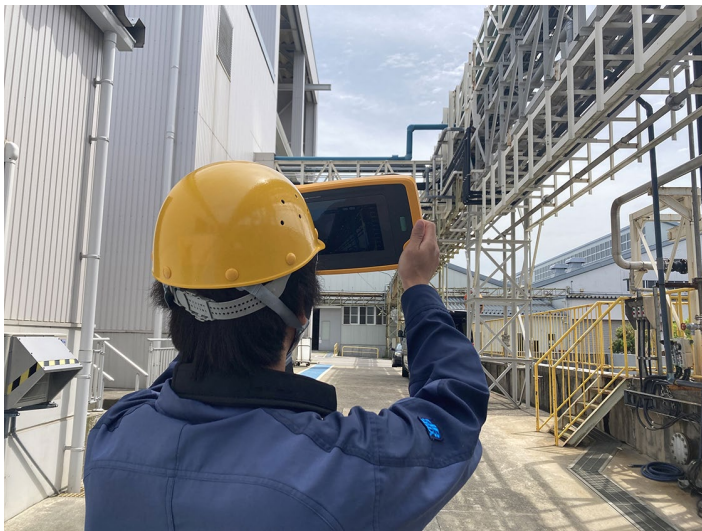
エア漏れビューアを用いた設備点検の様子
