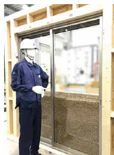
落雪を再現したシャッター側圧検証
