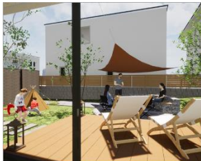
①お隣、歩行者からの視線カット 【デッキ+目かくしスクリーン+目隠し壁】
