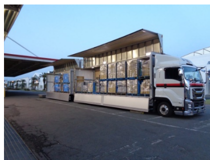
積載効率向上のために導入した連結トラック（「ホワイト物流」推進運動への取り組み）
