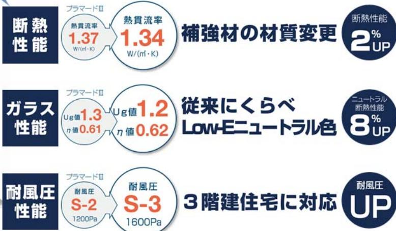
\*図中の性能は、たてすべり出し窓+FIX 連窓 [16513 サイズ] Low-E 複層ガラス ガス入樹脂スペーサー仕様の場合。一部窓種・サイズ除きます。
